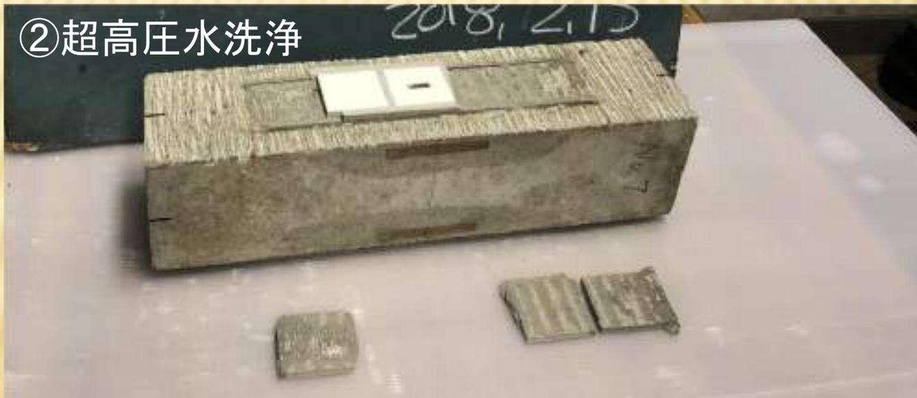
張付けモルタル凝集破壊 / 躯体破壊
