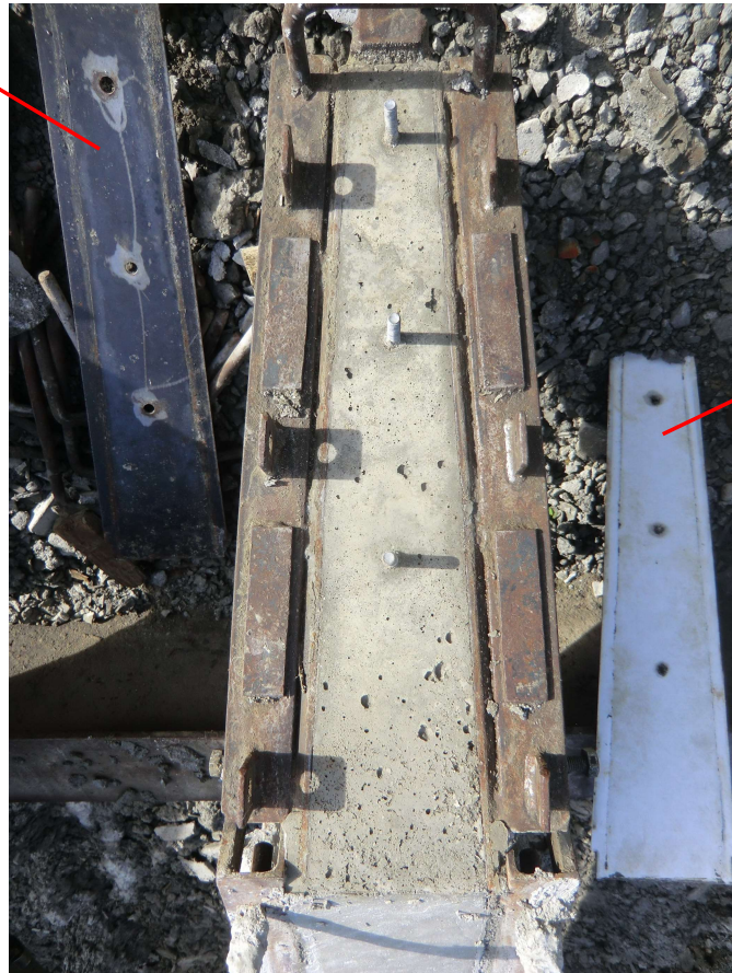
従来鋼製型枠 打設後表面（ピンホール等補修発生） （室外にて常温打設）
